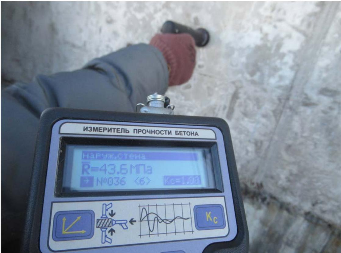
Фото 14. Измерение прочности бетона ж.б. стены
